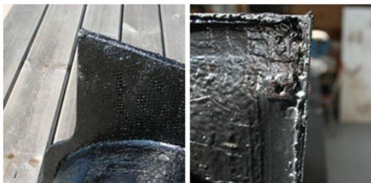
Avec un mastic-colle enduit sur toute la surface, j'ai collé cette grille contre la plaque de montage du couvre-tunnel, côté habitacle.
